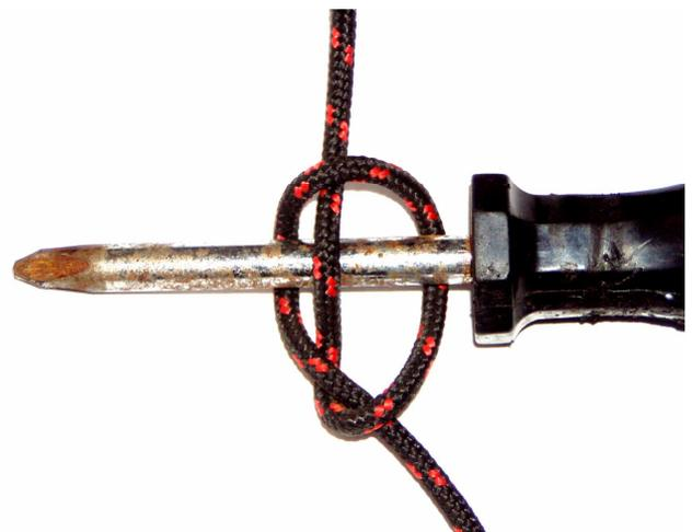
4. Nun einen Schraubenzieher oder ähnliches einfädeln. Dann den unteren losen Tampenteil anziehen und fertig ist der Knoten
