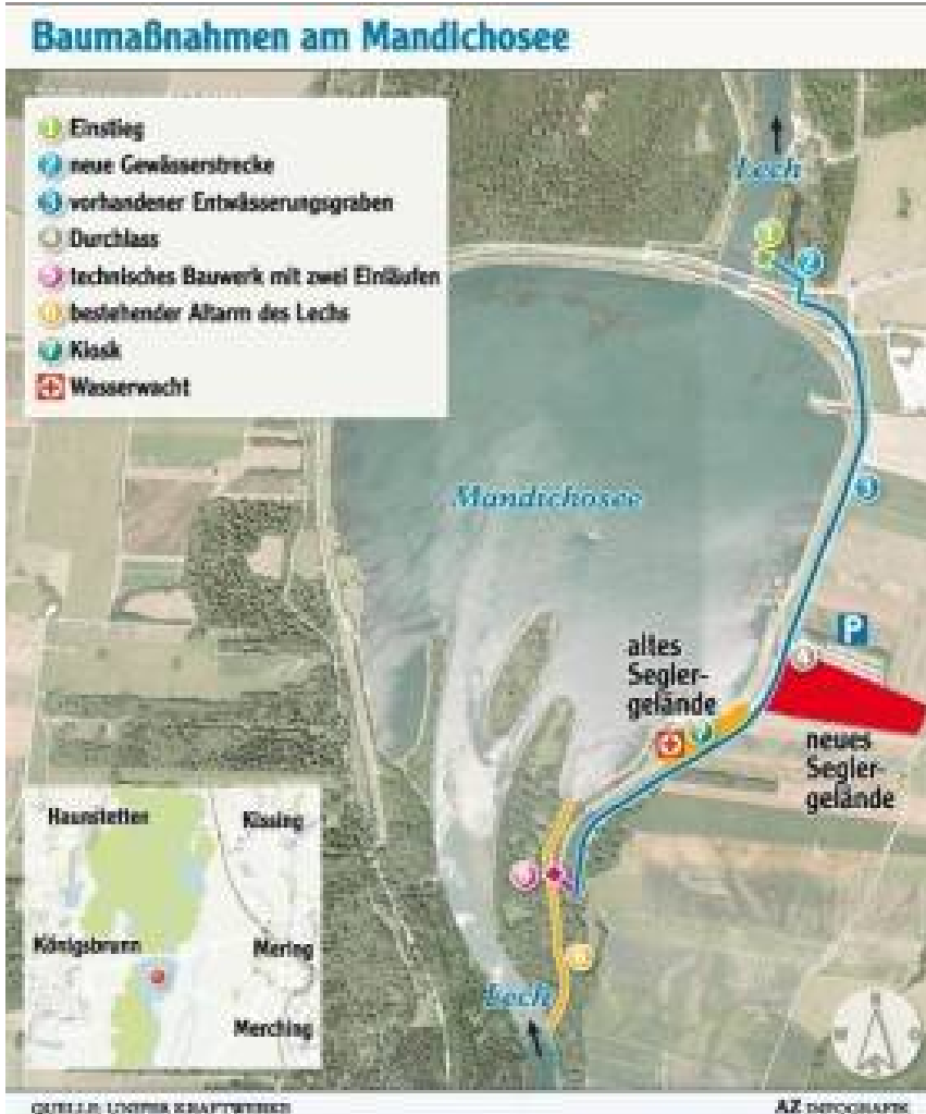
Am Ostufer des Mandichosees entsteht ein Wassergraben, in dem die Fische die ganze Staustufe "umschwimmen" können. AZ Infografik
